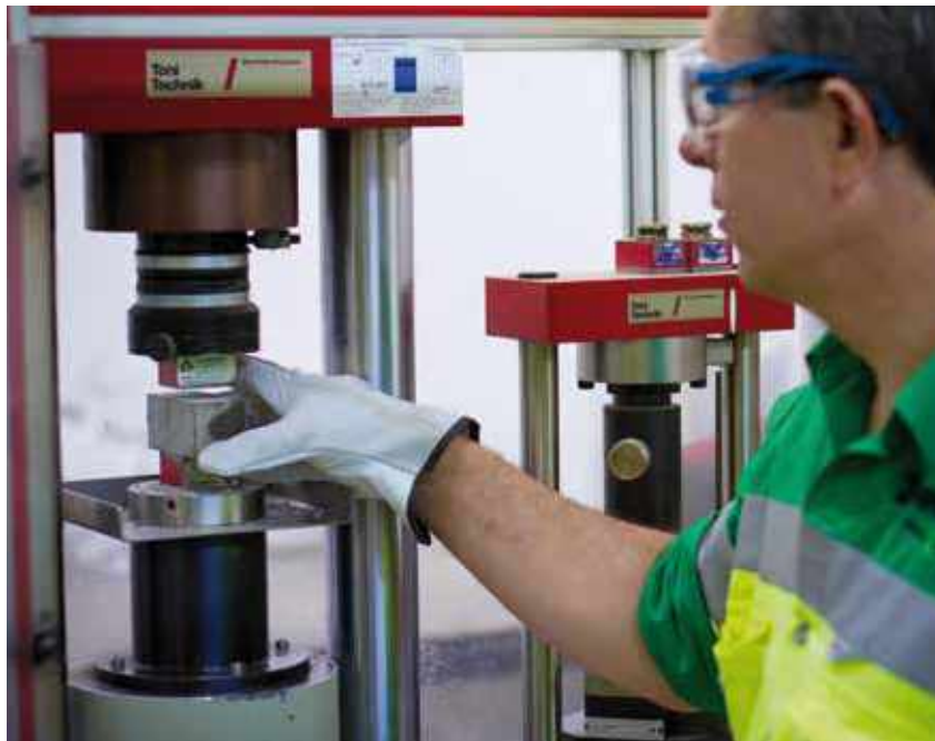
Δοκιμή θλίψης τσιμέντου από καταρτισμένο προσωπικό μας στο εργαστήριο του εργοστασίου
